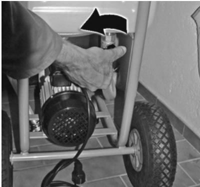
4. Påfyld forrådsbeholder og åbn kugleventilen
