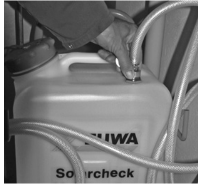
2. Monter returslangen på beholderen
